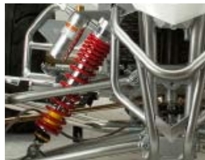
Plinski amortizerji . 3-področno nastavljivi, možnost nastavitve trdote, odzivnosti ter dolžine.
