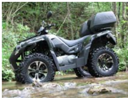
Velike 25 colske pnevmatike, skrbijo, da kljub zadnji osovini štirikolesnik ohranja izredno oddaljenost od tal.
