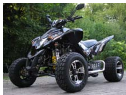
Cestna verzija : znižano podvozje ter nizko profilne gume.
