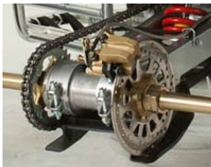
Zavorni diski , poskrbijo da se vozilo hitro ustavi.
