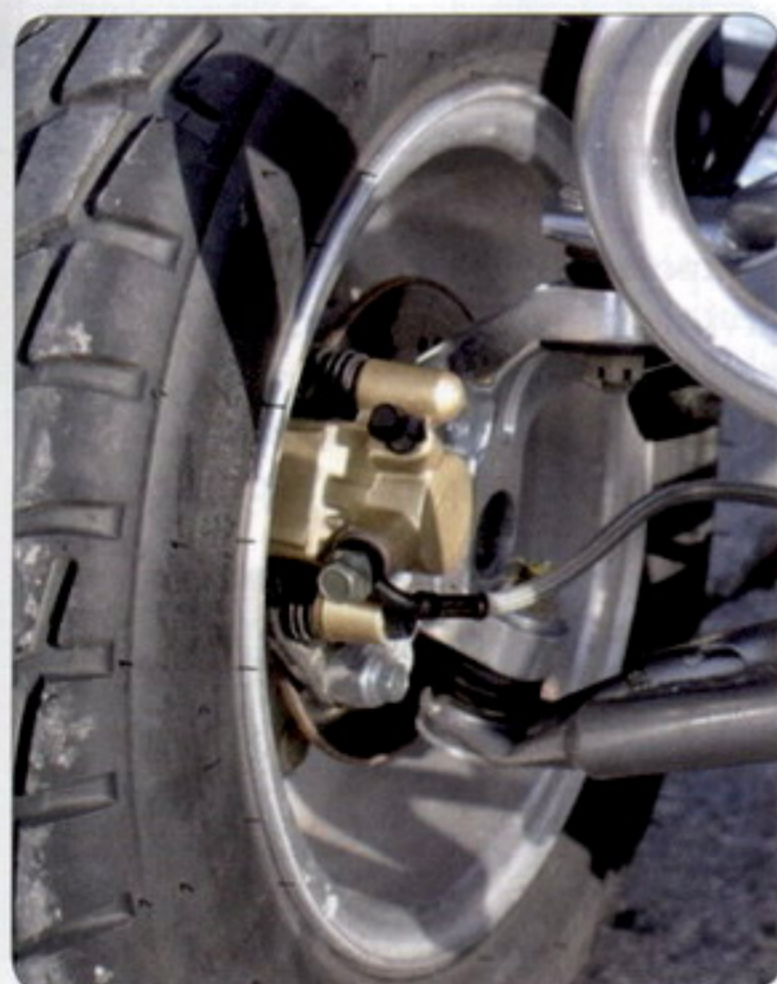
Hidravlične zavore delujejo zelo dobro in enakomerno a žal jih lahko krmilimo le preko nožne stopalke.
