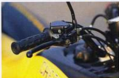
Prednje zavore: mehanske bobnaste, aktivira jih ročica na krmilu in tudi pedal, lepo odmerljive, ne preostre
